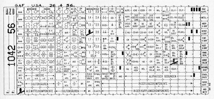
Abb. 6. Zeichenlochkarte (leicht verkleinert) für Azofarbstoffe der Firma Sandoz (Vorderseite)
