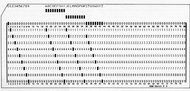
Abb. 4. IBM-Lochkarte (leicht verkleinert)
