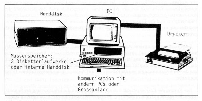
Abb. 1 Beispiel einer PC-Konfiguration
