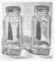
Abbildung 23: Feuchtkammer-Methode zur Prüfung der Schimmelpilz-
