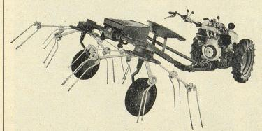
ASA FAHR-Kreiselheuer zu Einachstraktoren Für Rapid, Super, Spezial und 606
