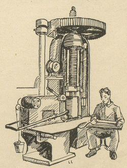
Mit mächtigen Pressen wird der Teig bei einem Druck von 100000 Kg. durch eine Matrizes (Hoblform) getrieben u. dabeizu Minen geformt.
