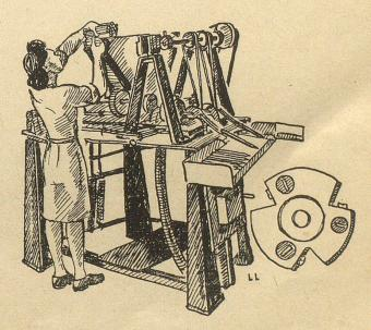
Dank einer großen Anzahl automatischer, mit Diamantfräsen versehenen Spizenmaschinen, die mit 12000 Umdrehungen in der Minute arbeiten, liefert CARAN D'ACHE, als einzige Bleistiftsabrik der Welt, alle Bleistifts gespitzt.
