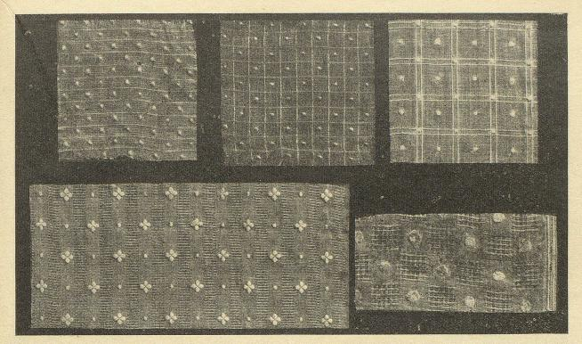
Bild 3. Mufter auf verdichtetem und gelockertem Boden.
