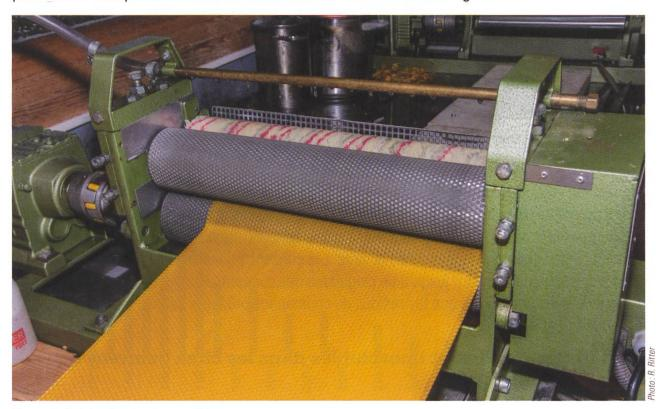
Figure 1 : Fabrication de cires gaufrées
