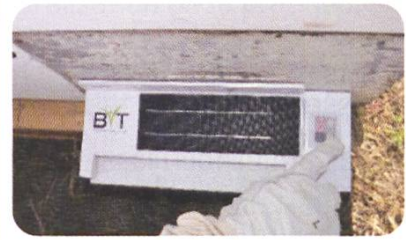
Le distributeur électro-mécanique permet une distribution adaptée à la ruche et à la culture
