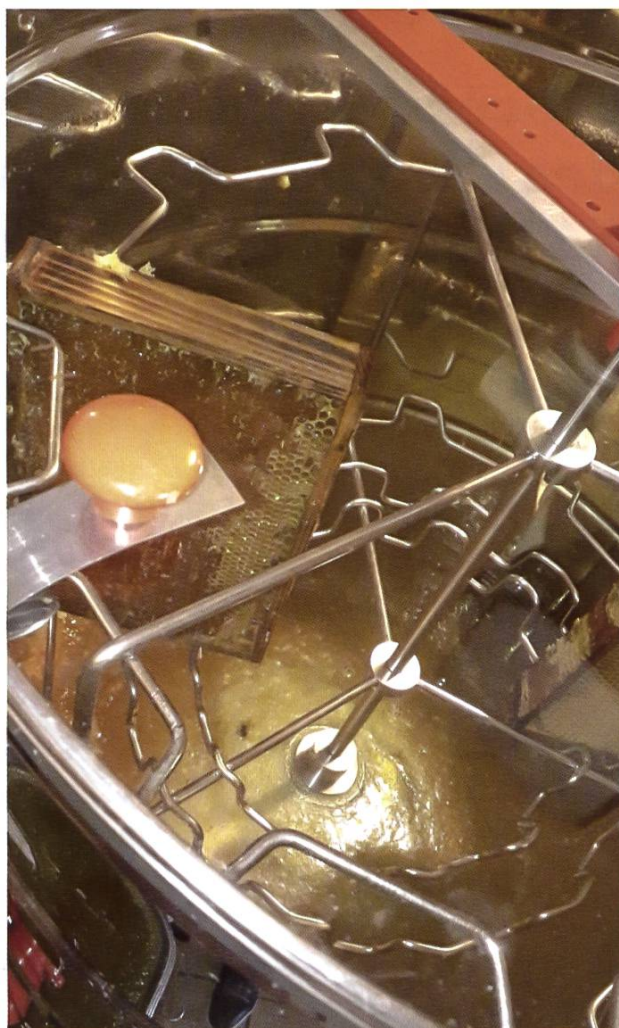
Placer les cadres par paires de même poids, toujours face à face: une méthode qui fonctionne pour équilibrer l'extracteur.
