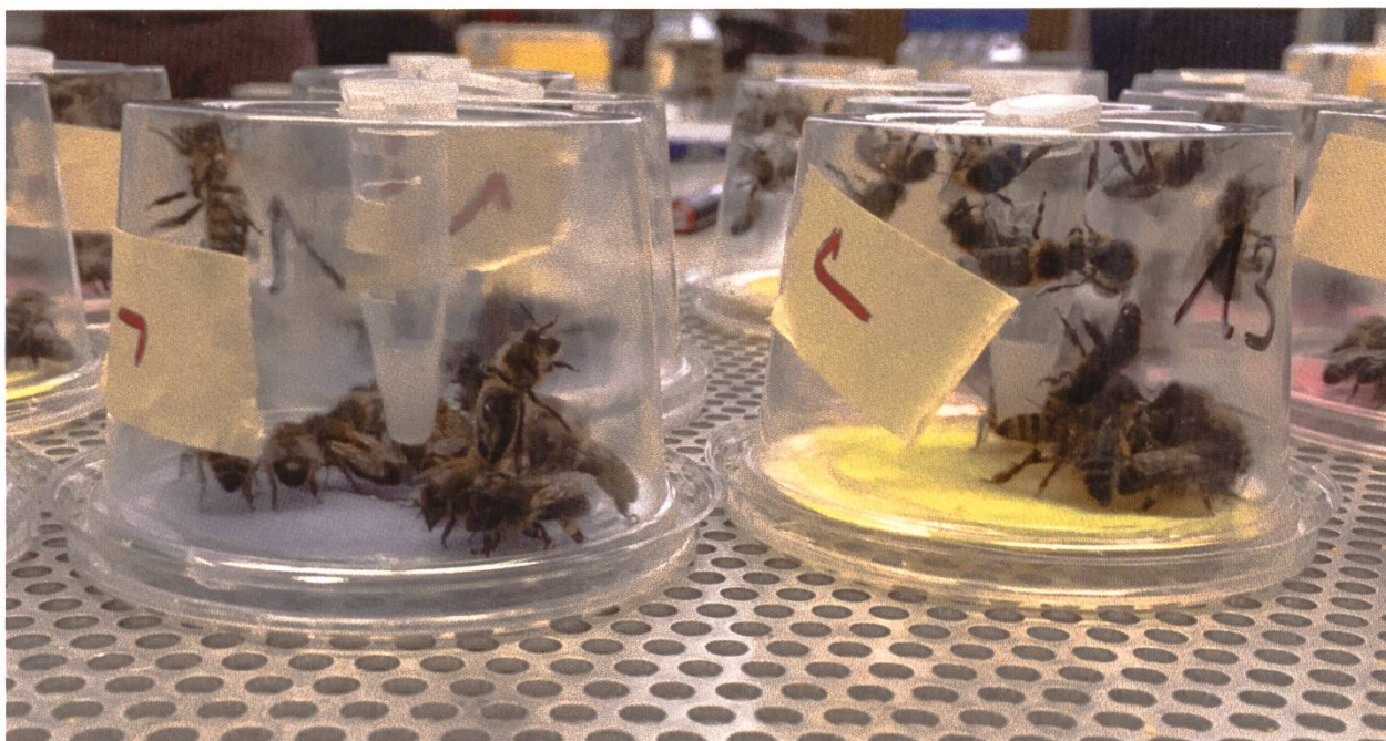
Test de toxicité avec des ouvrières adultes dans des cages de laboratoire pour déterminer l'effet des pesticides.
