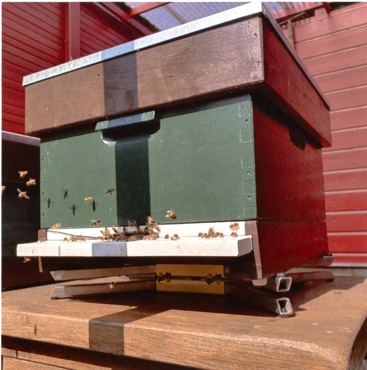
Le système BEEP, utilisé dans le projet B-GOOD, suit le développement de la colonie en direct en mesurant divers paramètres tels que le poids de la ruche et la température (Photo: Fondation BEEP, www.beep.nl )
