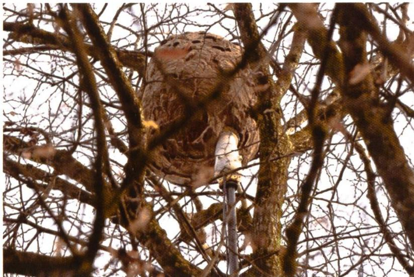
des intempéries, sous un toit, dans une cabane ou un garage... L'appareil plus puissant combinant air et vapeur permet de traiter les nids les plus gros, dits secondaires, qui abritent une colonie mature et sont construits plus tard dans l'année. Un réservoir d'eau chauffée jusqu'à vaporisation est surmonté d'un ventilateur qui envoie la vapeur dans le tube perforé. Alimenté par une source électrique, l'appareil doit généralement être branché sur générateur d'une puissance de 2 kW.
