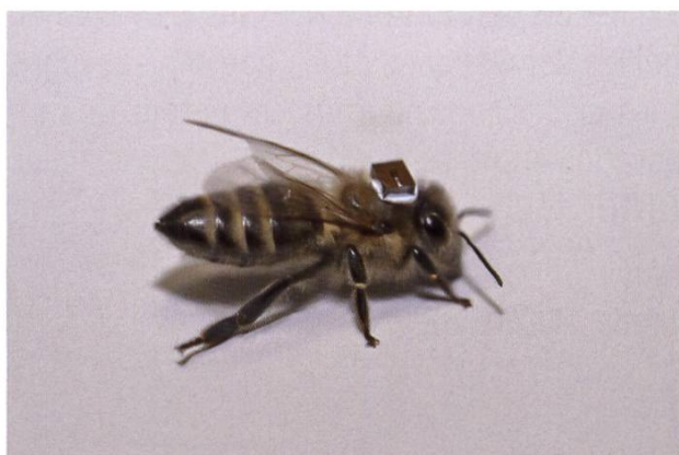
Abeille équipée d'une puce RFID
