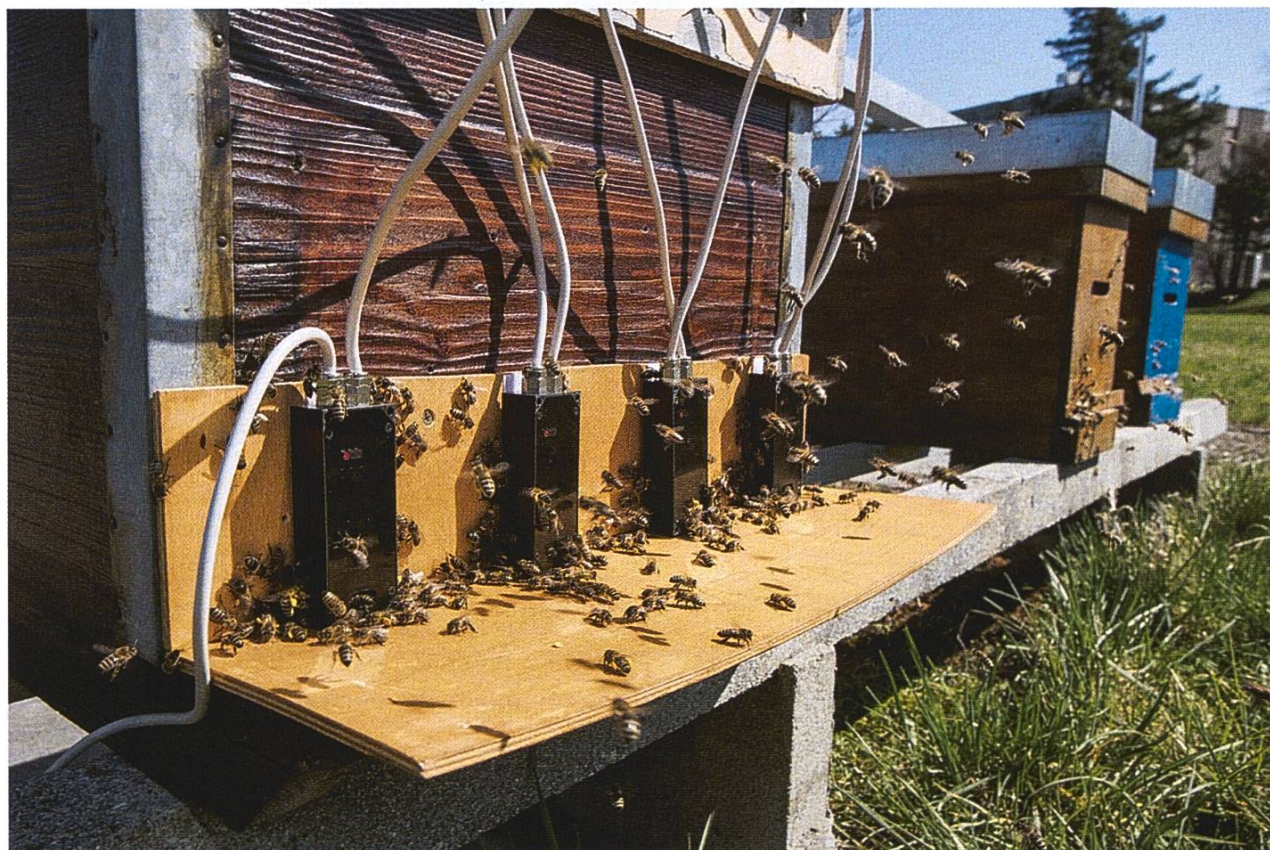
Ruche équipée de lecteurs RFID au trou de vol
