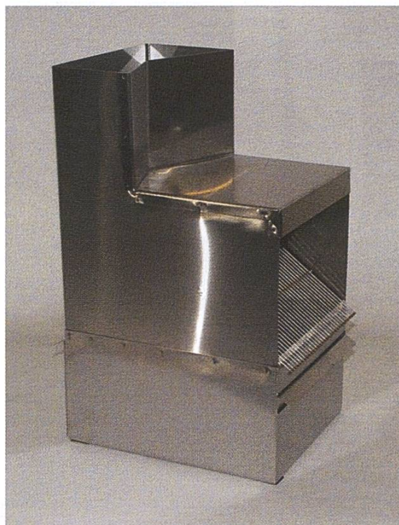
Figure 4: le séparateur utilisé pour la séparation de la cire. L'appareil s'ajuste sous la machine à récolter le pain d'abeille « Bee Bread Harvester BBM Mini ».
