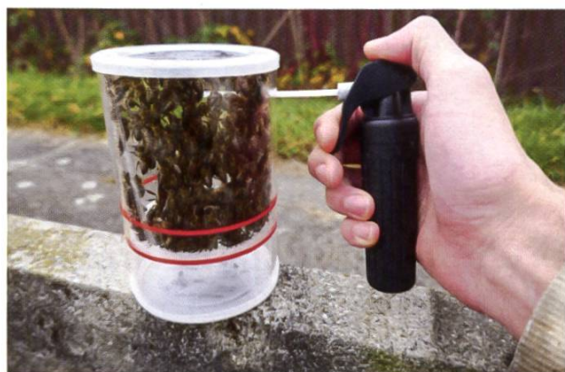
Figure 4: Du \text{CO}_2 est injecté dans le récipient du Varroatester, ce qui endort les abeilles. (Photo: Agroscope-CRA)
