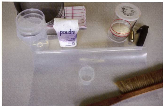
Figure 2: Matériel nécessaire pour la mesure du taux d'infestation par varroa avec les deux méthodes: sucre glace (en haut à gauche), \text{CO}_2 avec le Varroatester (en haut à droite). (Photo: Agroscope-CRA)
