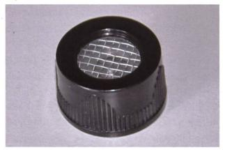
Figure 1: Protection de la sonde avec un bouchon en plastique, un grillage et une rondelle en caoutchouc. A gauche, les différents éléments ; à droite, la sonde prête à être placée dans la colonie.
