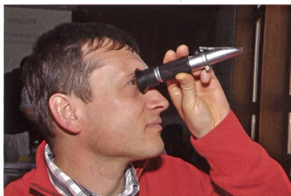
Photo 3 – La teneur en eau peut être déterminée de manière précise à l'aide d'un réfractomètre. Cependant, celui-ci doit alors être utilisé correctement. (Photo: Ruedi Ritter)
