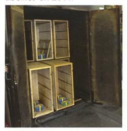
Essai de désinfection du matériel apicole dans un four industriel en collaboration avec des apiculteurstrices du Canton de Glaris: 18 ruches suisses avec enregistrement de la température dans le four.
