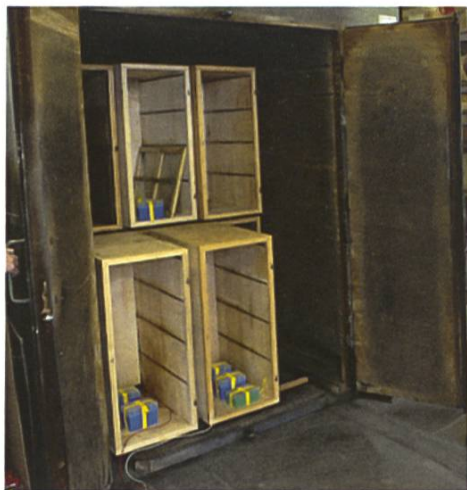
Essai de désinfection du matériel apicole dans un four industriel en collaboration avec des apicultrices du Canton de Glaris: 18 ruches suisses avec enregistrement de la température dans le four.
