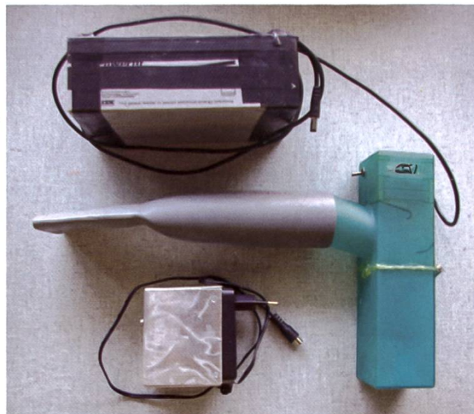
Illustration 1 : Premier prototype de l'appareil à ultrasons qui a été utilisé dans l'essai de 2005. Il fonctionnait grâce à une petite batterie qui pouvait être rechargée sur le réseau.
