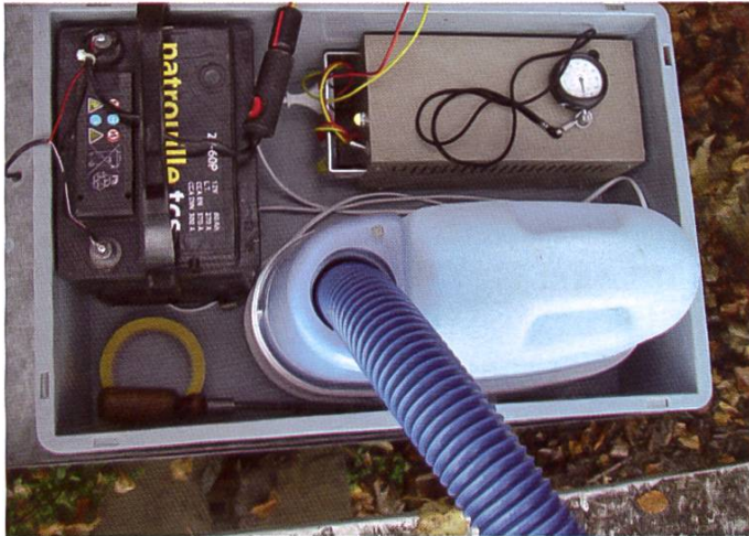
Illustration 4: Appareil à ultrasons adapté, fonctionnant avec batterie de voiture, et transducteur pour le traitement à l'acide oxalique. Appareil utilisé dans les essais de 2006 et de 2008.
