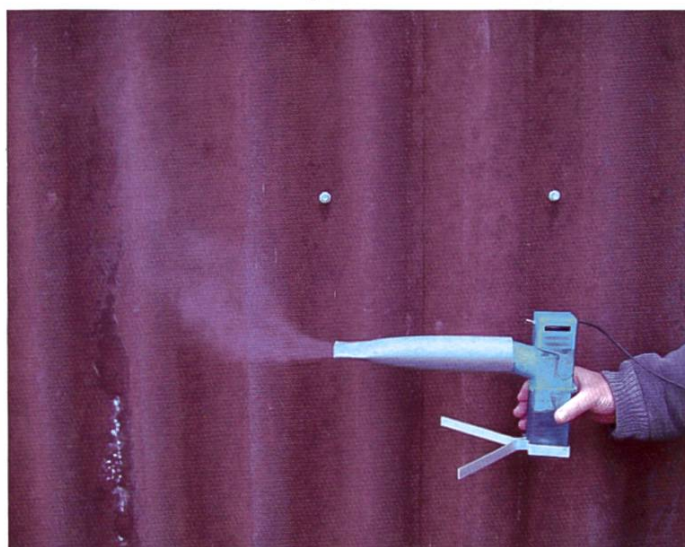
Illustration 2: Débit de l'aérosol avec le premier prototype de l'appareil à ultrasons utilisé dans l'essai de 2005.
