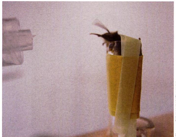
Ce dispositif permet de transmettre la substance odorante à l'antenne de l'abeille.
