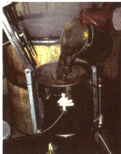
Dans le **cérificateur les déchets de cire** et les rayons peuvent être fondus de mi-mai à mi-août de façon peu coûteuse. Si la construction du cérificateur est parfaite, le rendement est aussi élevé que l'extraction par la vapeur. Le cérificateur doit remplir les conditions suivantes:
