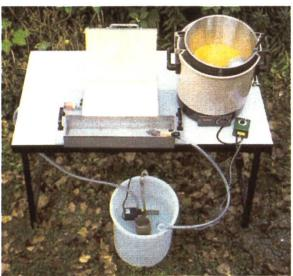
Moule à cire gaufrée avec refroidissement à eau en circuit fermé
