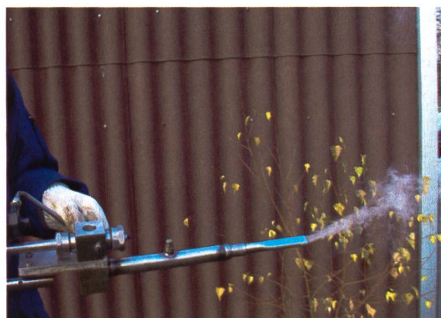
Photo 2: jets puissants d'acide oxalique sublimé grâce au ventilateur
