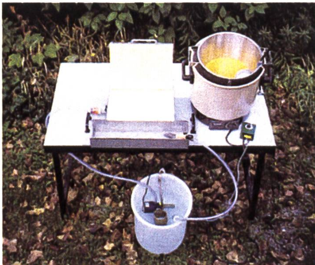
Moule à cire gaufrée avec refroidissement à eau en circuit fermé
