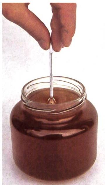
1. Enfoncer l'appareil dans le miel jusqu'à la limite blanche.
