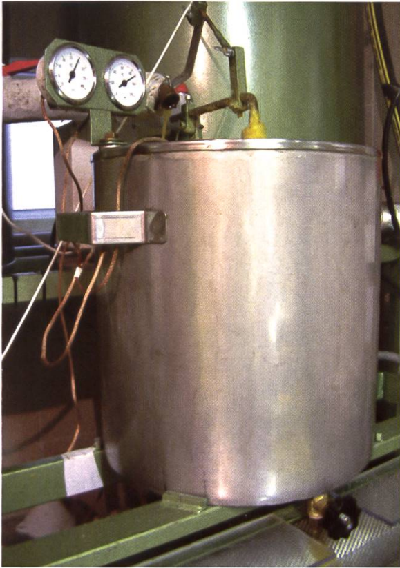
Cuve de stockage avant la coulée de la cire entre les matrices, réglage de la température précis. (Photo RSA)
