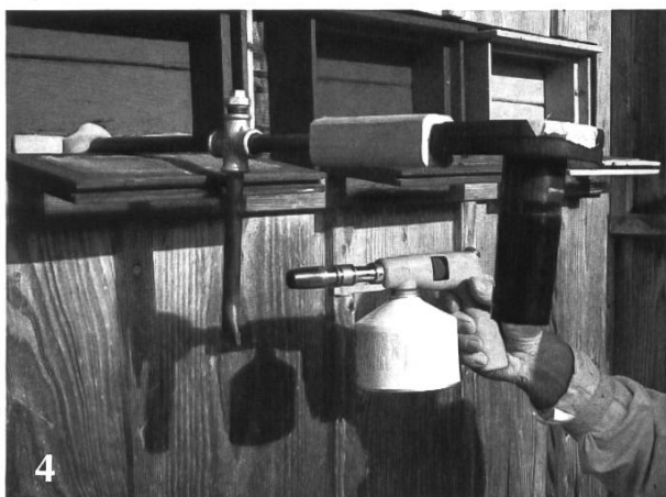
Evaporateur à gaz « Krüso ».
