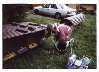
Illustration 5: L'apiculteur en train d'introduire l'évaporateur Varrox® par le trou de vol. Au premier plan, le capteur avec la tête de prélèvement. A droite la pompe à circulation pneumatique et l'appareil de mesure du volume.
