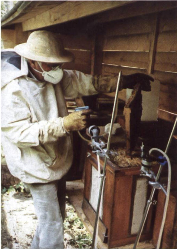
Illustration 3: Mise en place d'un capteur monté sur une tige à proximité du lieu de travail de l'apiculteur, traitant par pulvérisation un cadre sorti avec une solution d'acide oxalique.
