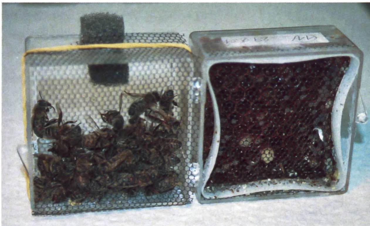
Le test comportemental a pour objectif de montrer si des odeurs peuvent attirer les acariens vers les cellules du couvain. Cagette ouverte avec la partie abeilles et la partie couvain.
