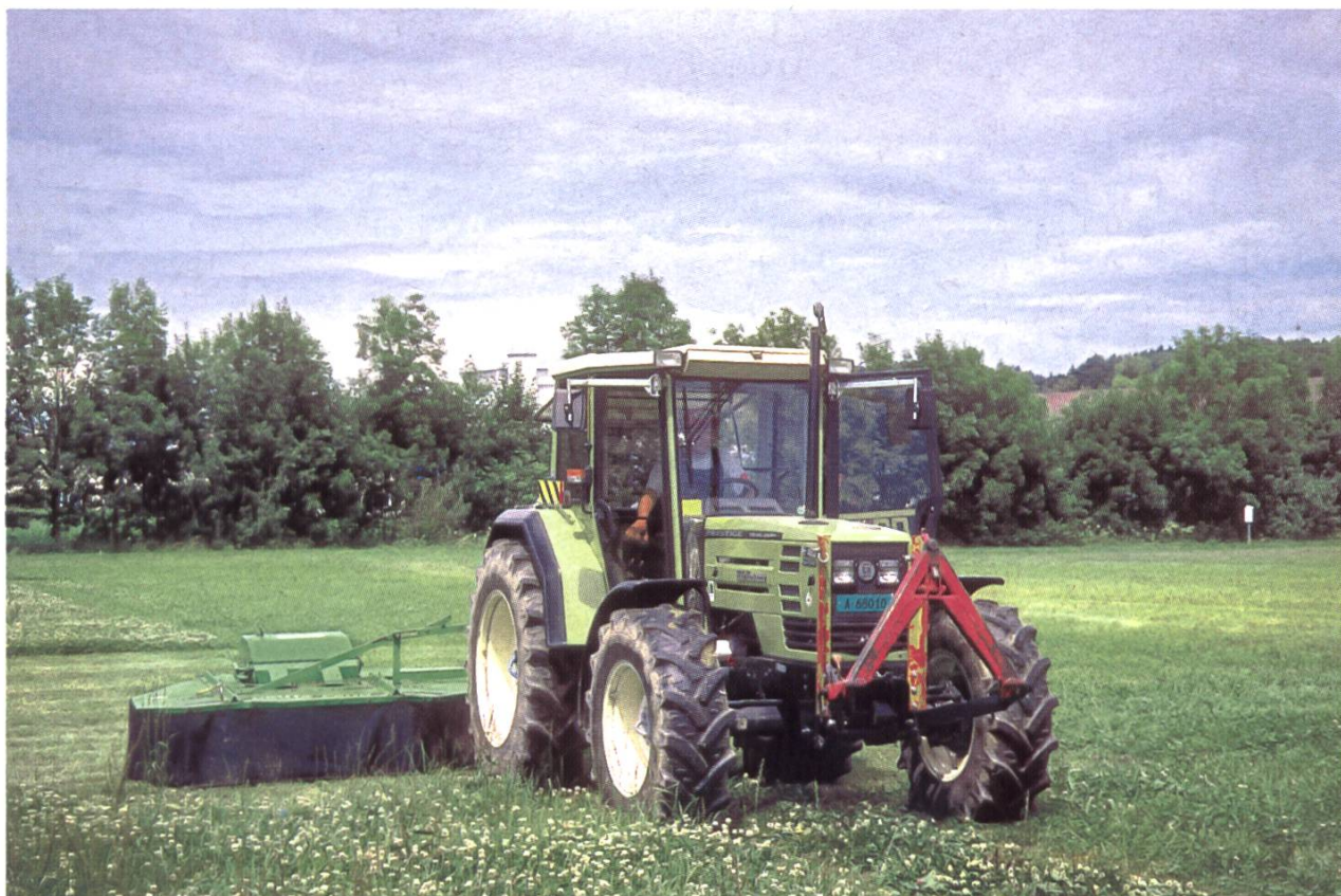
Fig. 4. Tracteur avec faucheuse latérale lors du fauchage du trèfle blanc.
