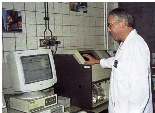
Analyse HPLC servant à déterminer les valeurs absolues des résidus d'antibiotiques.
