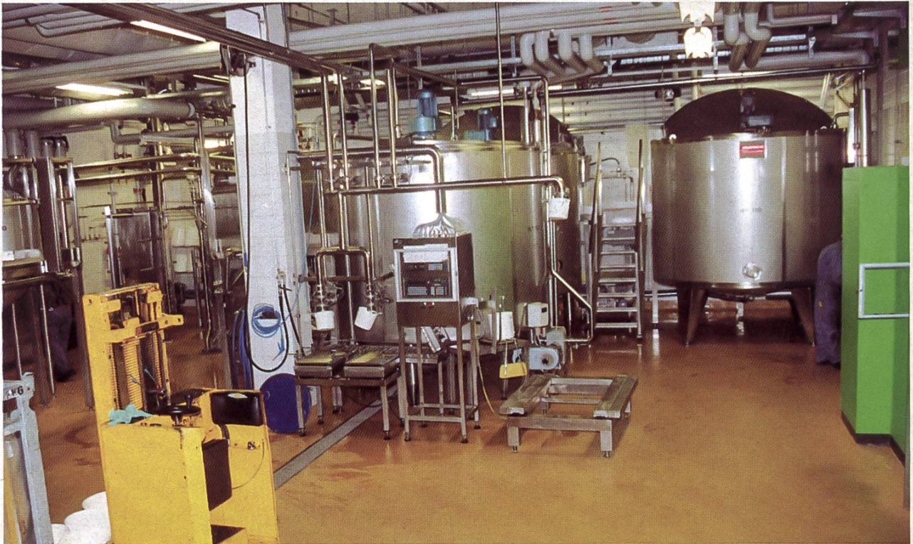
L'installation impressionnante du « brassage » du miel, où des quantités importantes de miel sont filtrées et peuvent prendre la consistance de la crème.
