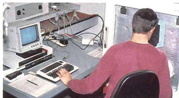
Figure 3b – Une alvéole est placée sous une loupe munie d'une caméra vidéo. Les observations s'effectuent à l'aide des oculaires de la loupe qui émergent à travers la porte de l'incubateur ou sur le moniteur de la vidéo. Photo J. Hättenschwiler.
