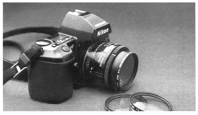
Pour diminuer cette distance, on trouve dans le commerce des lentilles d'approche qui se placent simplement sur le pas de vis normal de l'objectif. Lors de l'achat, indiquer le diamètre du filetage. La gamme de prix varie entre 30 et 40 DM. Il est conseillé d'acquérir un jeu de 3 lentilles de puissances différentes. Pour un équipement achromatique, qui donne de meilleures photos, ca devient un peu plus cher.
