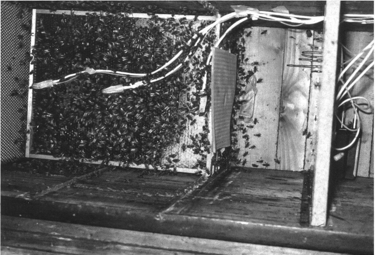
Sondes pour les prises d'échantillons d'air dans une ruche suisse. Dans notre essai nous n'avons utilisé que la sonde du milieu, placée dans le nid à couvain.
