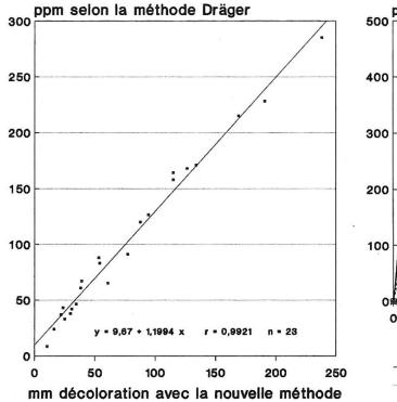
Fig. 1. Corrélation entre les valeurs mesurées selon la méthode Dräger et celles obtenues avec notre dispositif de mesure. Les concentrations en AF dans l'air de la ruche sont déterminées à l'aide de cette courbe d'étalonnage.
