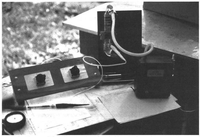
Durant le traitement, l'air de la ruche nécessaire à la détermination de la concentration en AF est pompé au moyen d'une pompe électroniquement.
