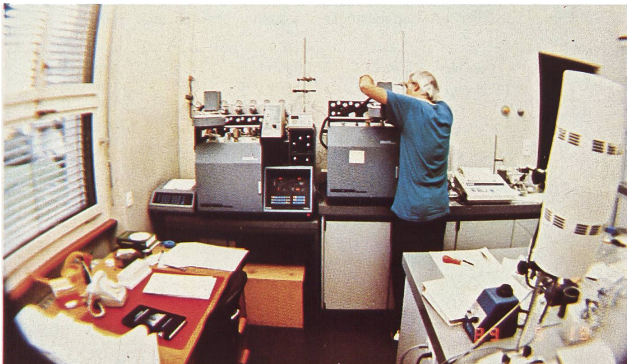
Fig. 1 Analyse par chromatographie gazeuse sur colonne capillaire. Cette méthode sophistiquée permet de détecter des traces de pesticides même infimes. Limite décelable pour le bromopropylate: 2,10^{-11} g.
