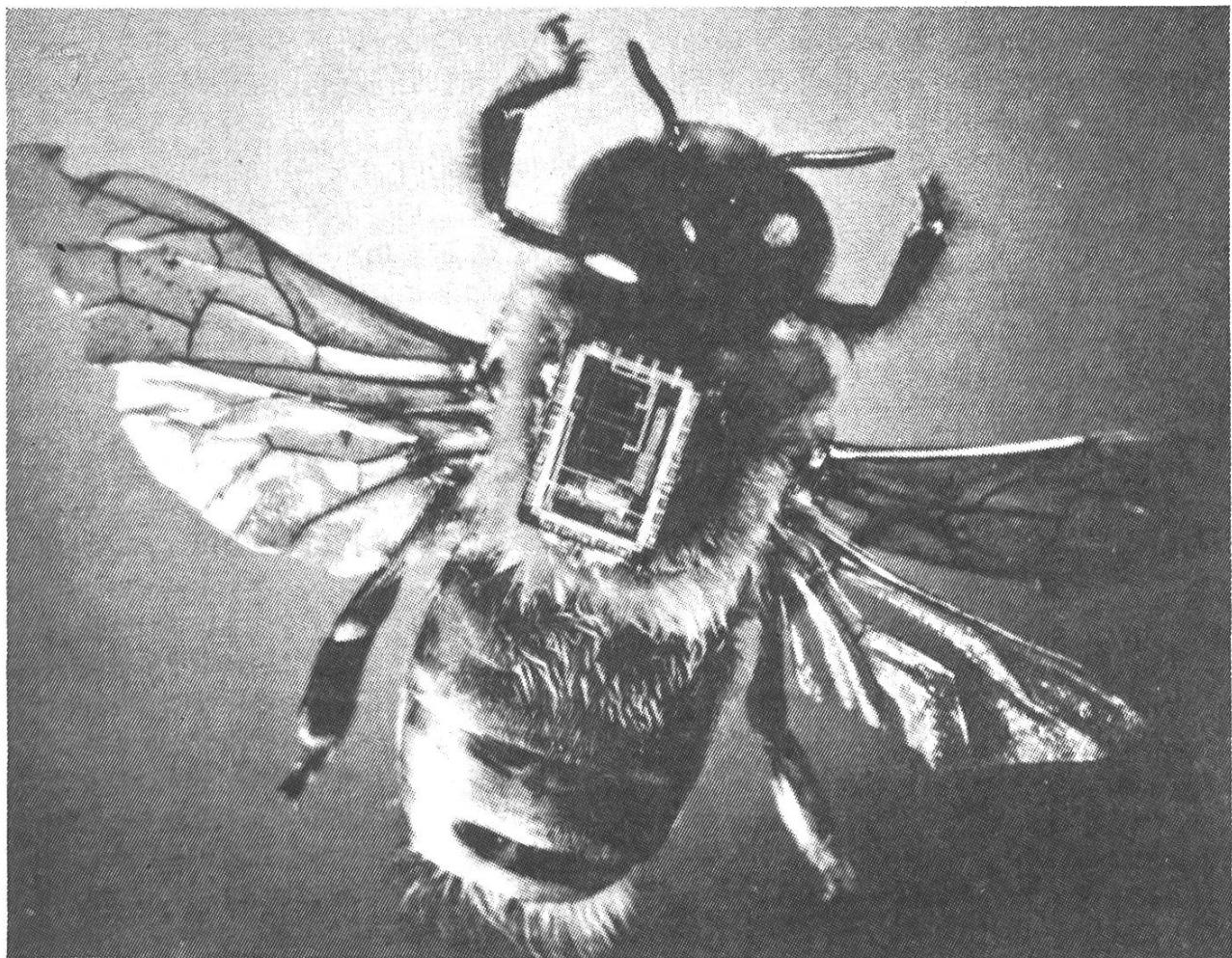
*Cet émetteur miniature d'ondes infra-rouges, collé pour expérimentation sur le thorax d'un faux bourdon par les ingénieurs du Laboratoire national d'Oak Ridge, Tennessee, pourrait être fixé à une abeille africanisée. Les signaux, audibles jusqu'à un kilomètre et demi, permettront aux savants de localiser les envahisseurs qui doivent, selon toute probabilité, émigrer du Mexique au Texas dans le courant de l'année prochaine.*
