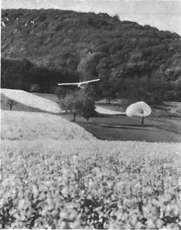
Fig. 6 Avion modèle réduit télécommandé avec sac remorqué pour la capture de butineuses volant à environ 1-1,5 m au-dessus d'un champ de colza en fleurs.
