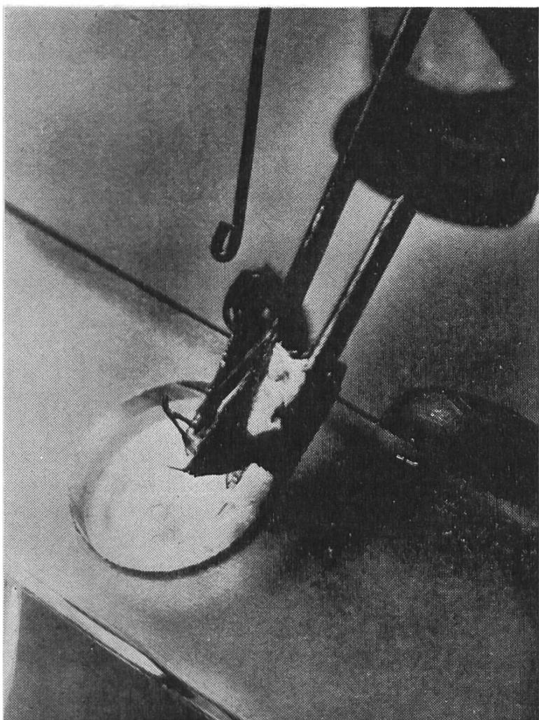
*Un frelon est immobilisé dans une pince sur un microscope porte-objet à cavité, dans laquelle le venin est récolté. Par le fil de fer au-dessus de la tête de l'animal, parvient l'excitation électrique. Le bout du doigt à droite sert de comparaison de grosseur. A remarquer aussi l'aiguillon du frelon et les gouttes de venin sur le porte-objet.*
