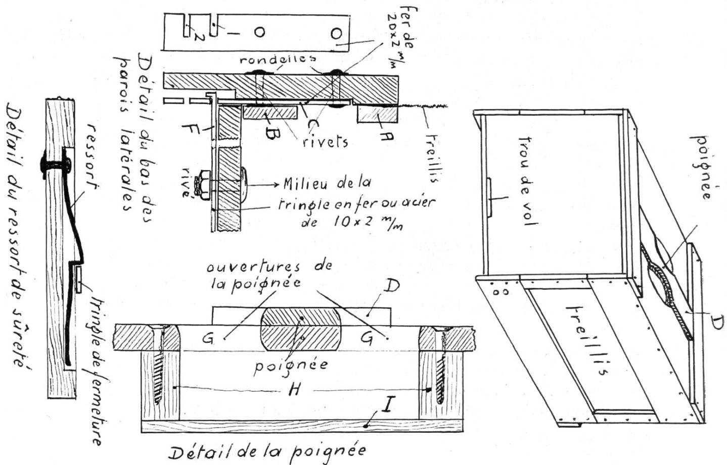
pour permettre à la tringle de fermeture (F) de pénétrer par rotation dans les encoches. Dans les encoches (1) la caisse est fermée, le trou de vol parfaitement assuré ; dans les encoches (2), le dessous se maintient plus bas et le trou de vol reste ouvert, permettant aux abeilles égarées lors de la cueillette de regagner le groupe.
