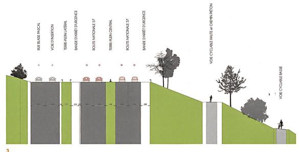
3 Vor der Erstellung des Gesamtplans: eine einspurige Autobahn, die trennt und ausschliesst. Avant la définition du programme: une solution autoroutière à voie unique et large qui coupe et exclut.
