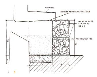
diese Weise wird alles auf die Wand auftreffende Regenwasser in die Pflanznische geleitet. Ausserdem bilden Steinkörbe die bergseitige Nische aus, um natürliche Erdfeuchte zuzulassen. Als Notbehelf installierten wir in regelmässigen Abständen Wasseranschlüsse für eine allenfalls manuelle Bewässerung. Die Pflanznischen mussten jedoch in den vergangenen 30 Jahren, wenn überhaupt, nur in einigen sehr trockenen Sommerwochen bewässert werden.
