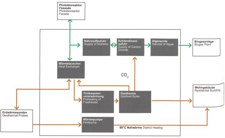
4 Funktionsschema der Fassadenelemente. Schéma montrant le fonctionnement des éléments de façade.
