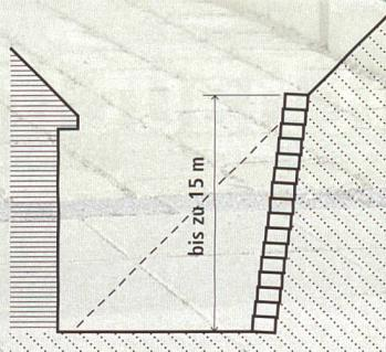
In Kombination mit einer Fundationsbewehrung können Stützmauern bis zu einer Höhe von 15 m realisiert werden – das sichert wertvollen Landgewinn.
