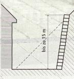
In Kombination mit einer Fundationsbewehrung können Stützmauern bis zu einer Höhe von 15 m realisiert werden – das sichert wertvollen Landgewinn.
