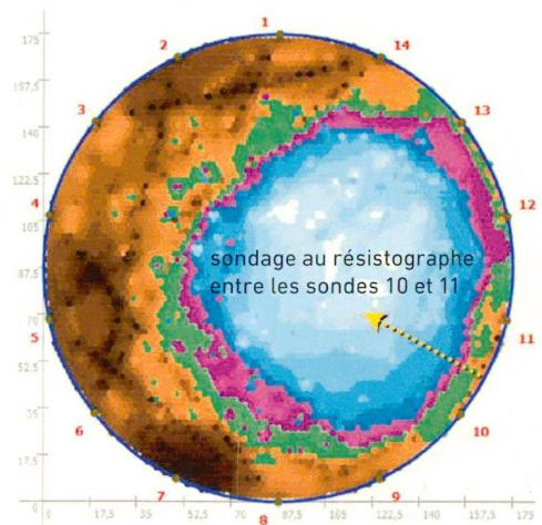
Le sondage au résistographe indique une résistance mécanique correcte à ce jour de la zone bleue de la tomographie.
