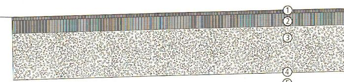
Asphaltstrasse: 1 Deckschicht aus Walzasphaltbeton. 2 Tragschicht aus Walzasphaltbeton. 3 Frostsichere Fundationsschicht aus Kies-sand. 4 Sandtrennlage. 5 Gewachsener Boden.
