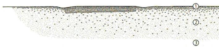
Erdweg: 1 Feinkörniger Boden (lehmhaltig, Ton, Silt), versetzt mit nebeneinander, quer zur Wegachse verlegten Bohlen oder Holzprügeln. 2 Gemisch aus Silt und Ton mit kiesigem Material. 3 Gewachsener Boden.
