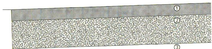
Betonstrasse: 1 Betonplatte. 2 Ungebundene Fundationsschicht. 3 Gewachsener Boden.
