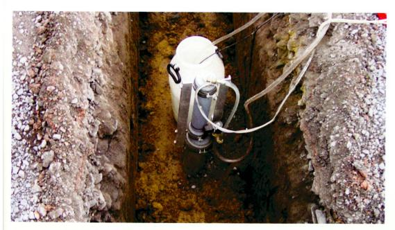
Bestimmung der Wasserdurchlässigkeit nach dem Open-End-Verfahren.
