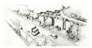
Die Umfahrungsstrasse Döttingen-Klingnau um 1978/80 wird von begrünten Lärmschutzwänden flankiert. Steinkorbelemente rhythmisieren die bergseitige Mauer. Zeichnung: Albert Zulauf.
