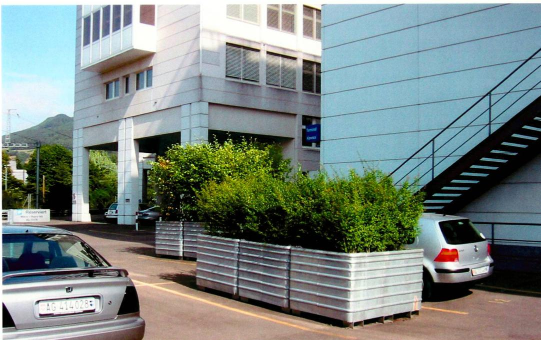
Für die Begrünung eines Parkplatzes der ABB wurde auf das Bild der im Areal präsenten Metallbehälter zurückgegriffen. Über Kufen bleiben die Behälter für kurzfristige Nutzungsänderungen mittels Gabelstapler verschiebbar.
