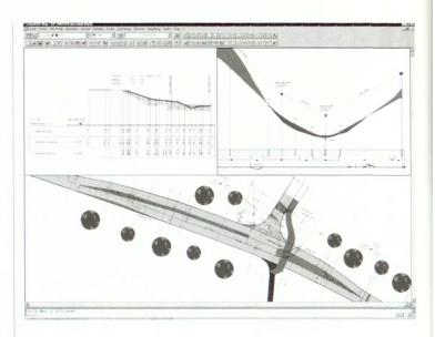
eine Auswahl von Profilen, lassen sich automatisch angeordnet zeichnen und sind sofort kontrollierbar. Natürlich enthalten die Profile auch den geschnittenen Geländehorizont und die Böschungen.
