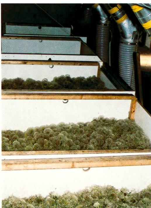
**Trocknung mit Hilfe von Paloxen**
